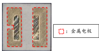
图 4. NFSWE11A 背面（金属电极外观）
